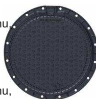
KDL81B / KDK81B EUROPA D400 Litinový poklop v litinovém rámu, se zajištěním proti krádeži Hmotnost: 62 kg
